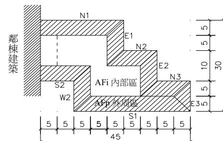
圖 6 緊接鄰棟建築物或使用共同壁時，該部位樓地板面積不計入 AFp
