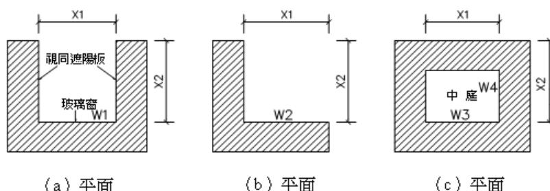
$W_1$ 、 $W_2$ 、 $W_3$  整體外牆之開窗玻璃部分均以深度比  $= x_2/x_1$  遮蔽角度計算  $Ki$  值。但(b)圖  $W_2$  外牆因僅具一側翼，因此其遮陽效果應予折半計算，即  $Ki = (1 + Ki) \div 2$
